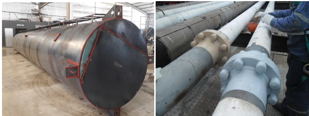
Figura 01: Foi utilizado nos cordões de solda o SHOP PRIMER, que é um primer epóxi que aceita solda.
